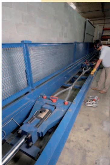
Disponemos de un banco de pruebas para ensayos de carga, fatiga, y rotura a los que sometemos todos los productos Tenso, asegurando que los procesos productivos cumplen las Normas Internacionales.
